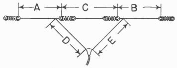
Fig. 22-17.—"V" doublet antenna.
