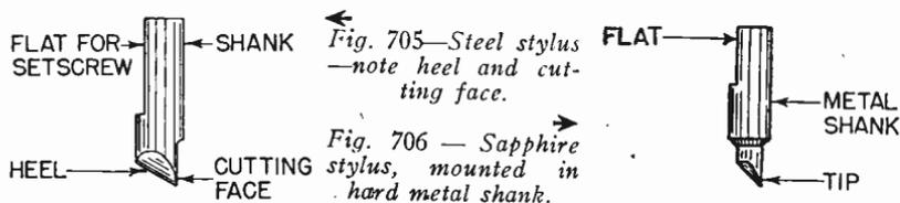
Fig. 705—Steel stylus
