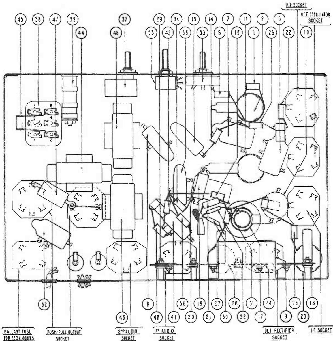
Fig. 4—Parts Diagram
