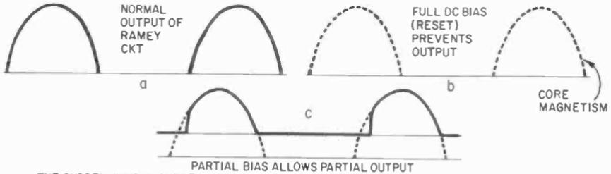
THE SUDDEN JUMP IN CURRENT IS CAUSED BY THE SUDDEN REVERSAL OF CORE SATURATION
