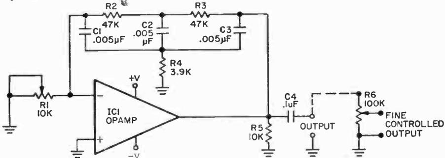
**PARTS LIST FOR NOTCH FILTER OSCILLATOR**
