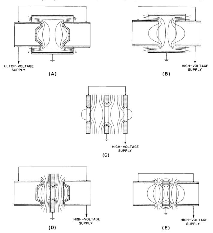
Figure 10. Electrostatic, Einzel-Type Focusing Lenses
