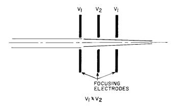
Figure 37. An Einzel-Lens Electrostatic Focusing Arrangement
