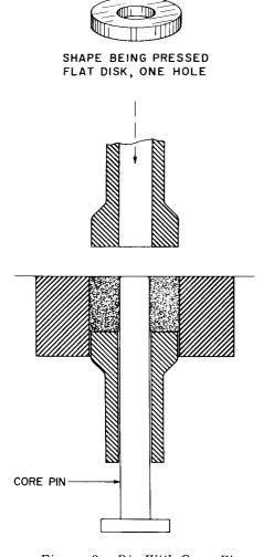
Figure 3. Die With Core Pin
