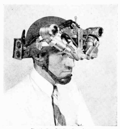
Fig. 12-Type Z Helmet Binocular.
