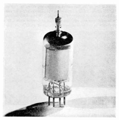
Fig. 14-1654 Rectifier Tube.
