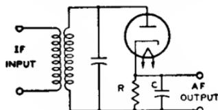
Fig. 22—Basic diode-detector circuit.
