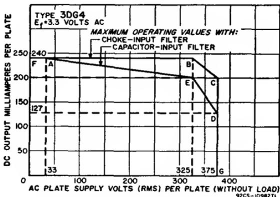
**TYPICAL OPERATION WITH CAPACITOR INPUT TO FILTER**
