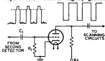
Fig. 80—Sync-separator circuit.
