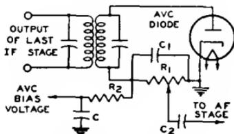
Fig. 61—Automatic-volume-control (avc) circuit.
