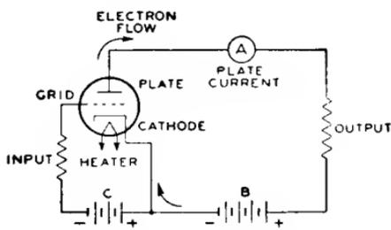
Fig. 6—Basic triode circuit.
