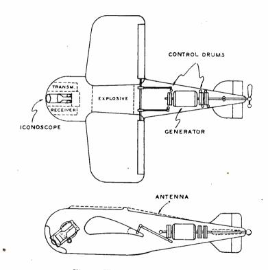
Fig. 1-The Flying Torpedo.
