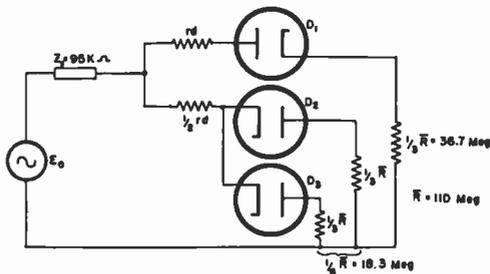
Fig. 19—Equivalent rectifier load circuit.
