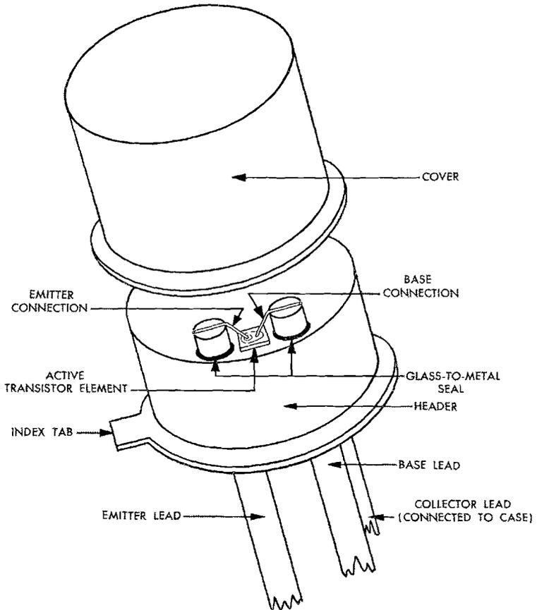
TYPICAL SILICON SWITCHING TRANSISTOR
