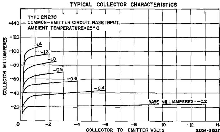
**TYPICAL OPERATION IN CLASS A AF AMPLIFIER CIRCUIT**
