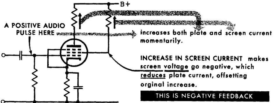
**WHEN A CAPACITOR IS CONNECTED BETWEEN SCREEN AND GROUND,**
