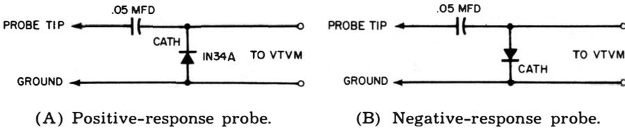
**Fig. 105. Half-wave rectifier probes.**
