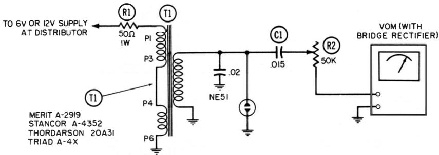
**Fig. 46. Electric tachometer arrangement.**
