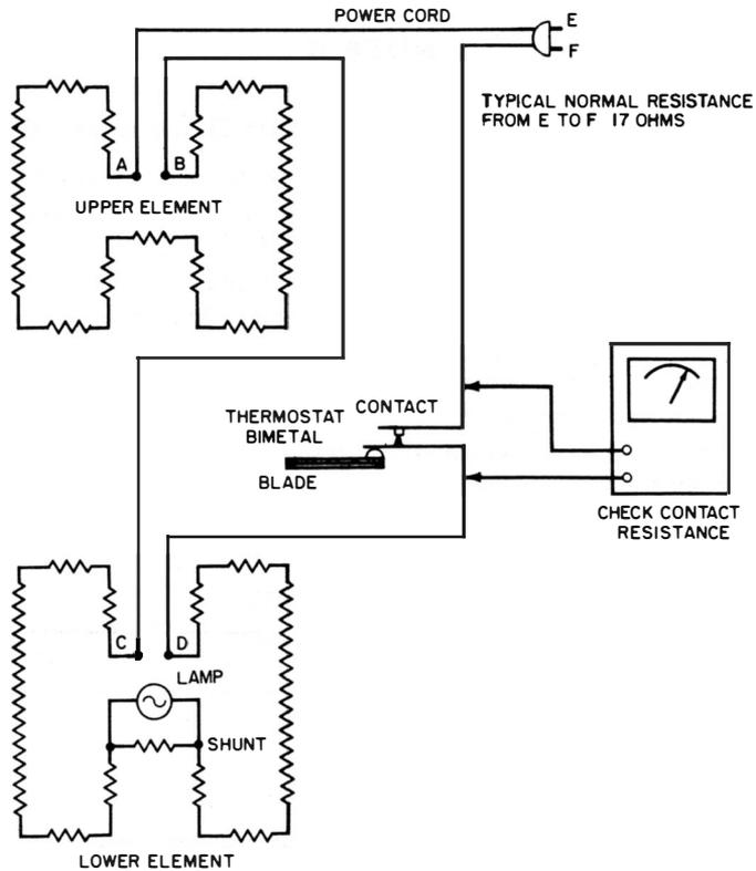
**Fig. 9. Wiring diagram of a waffle iron.**
