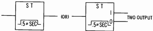
Fig. 4-9. Schmitt trigger symbol.
