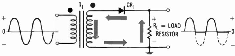
Fig. 4-9. Half-wave rectifier.
