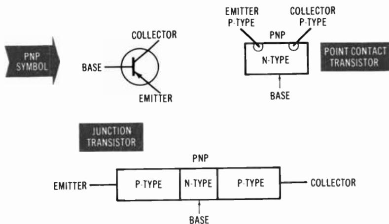
**Fig. 3-21. Pnp transistor symbol.**
