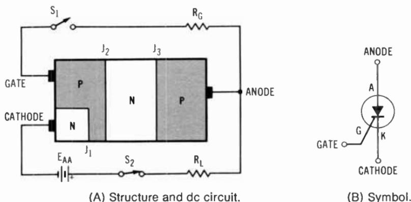
**Fig. 8-14. Silicon controlled rectifier.**
