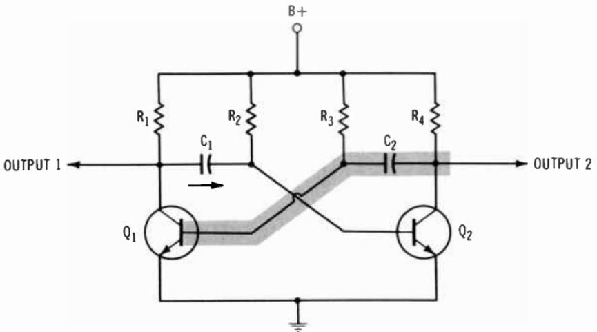
**Fig. 7-9. A multivibrator circuit.**
