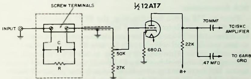
Fig. 5-7. Altec Lansing 359A input circuit.
