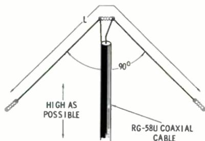
Fig. 10-6. Inverted V antenna.
