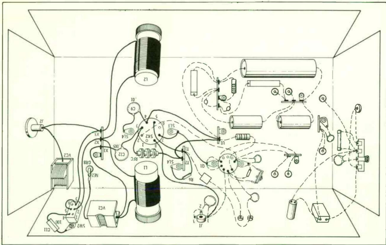
Fig. 6-7. Wiring the amplifier.
