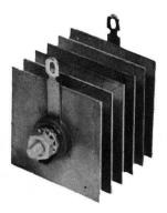
Fig. 6-1. A selenium rectifier.
