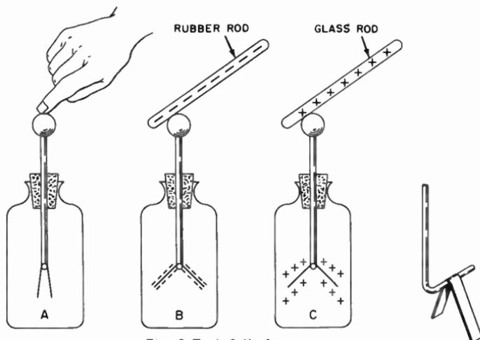
Fig. 3-7. A foil electroscope.
