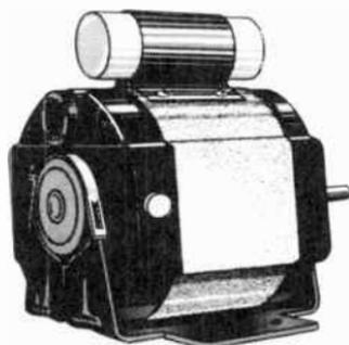
Fig. 13-24. A capacitor-start motor.
