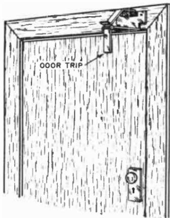
Fig. 14-11. How a door switch works.
