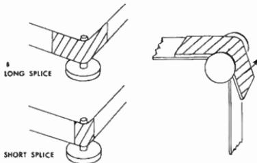
FIGURE 3A & 3B. SPLICE LENGTH AND BEND RADIUS
