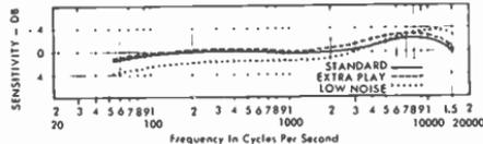
FIGURE 1. FREQUENCY RESPONSE — TAPE AND RECORDER
