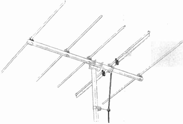
Fig. 11-19. Multielement Yagi antenna.
