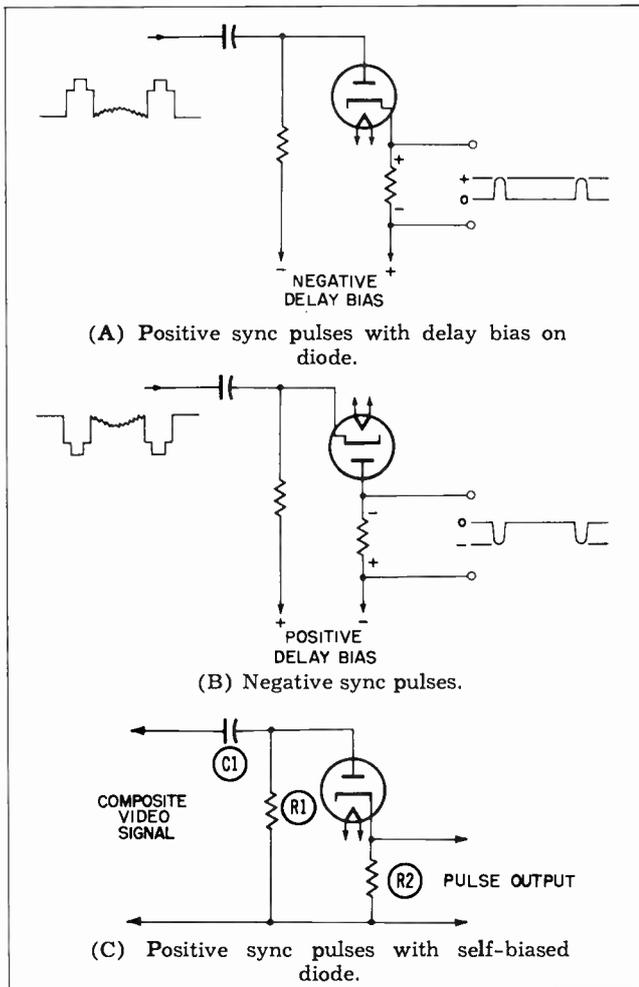
Fig. 10-4. Diode sync-separation circuits.
