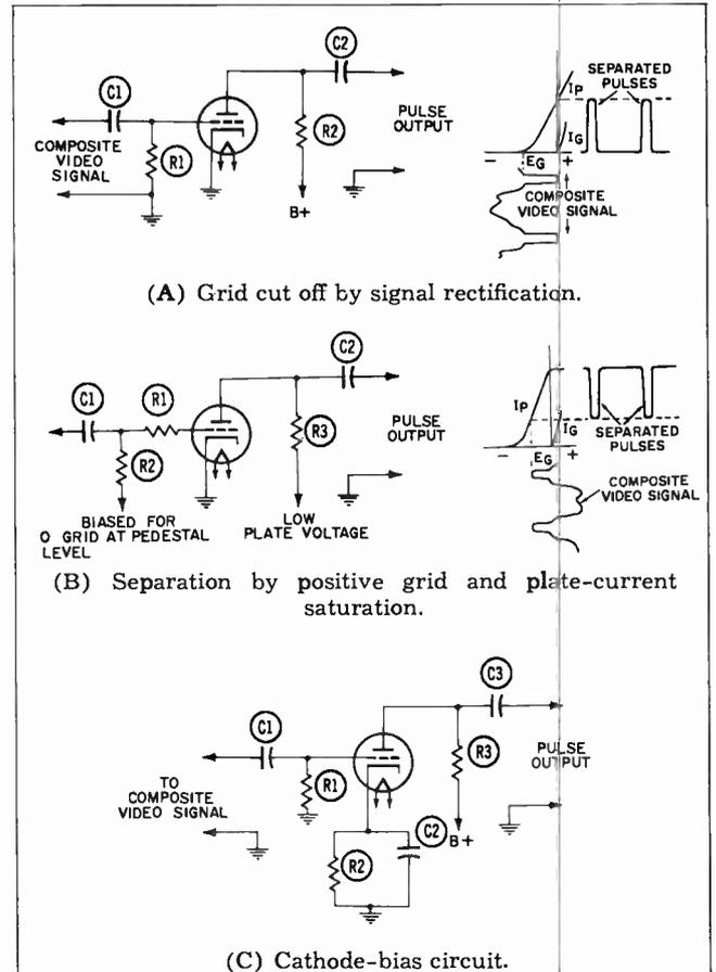
Fig. 10-5. Triode sync-separation circuits.
