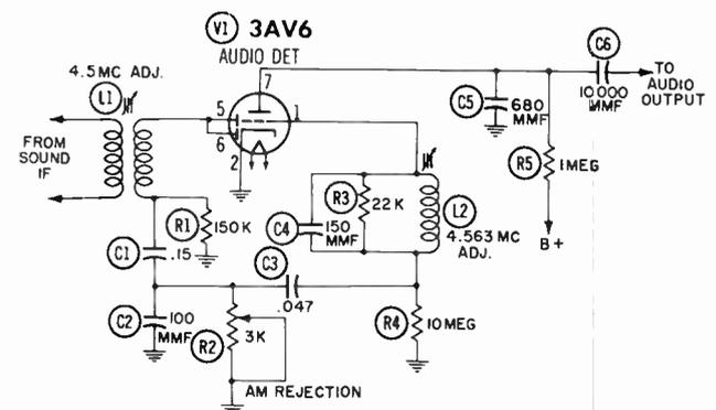
Fig. 14-11. The delta sound detector.
