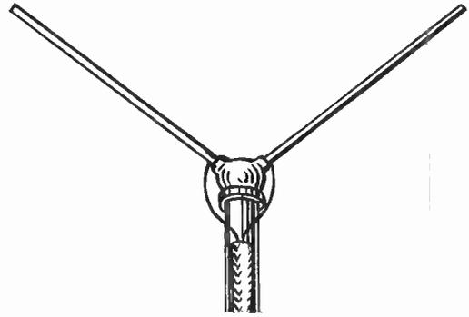
Fig. 11-14. The V antenna.
