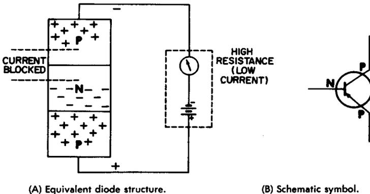
Fig. 1-9. The PNP transistor.
