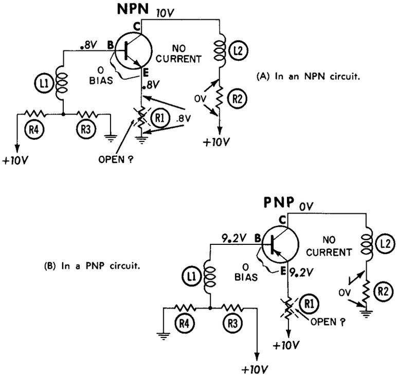
Fig. 6-3. Open emitter circuit.
