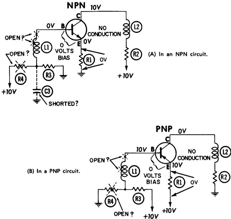
Fig. 6-2. Open base circuit.
