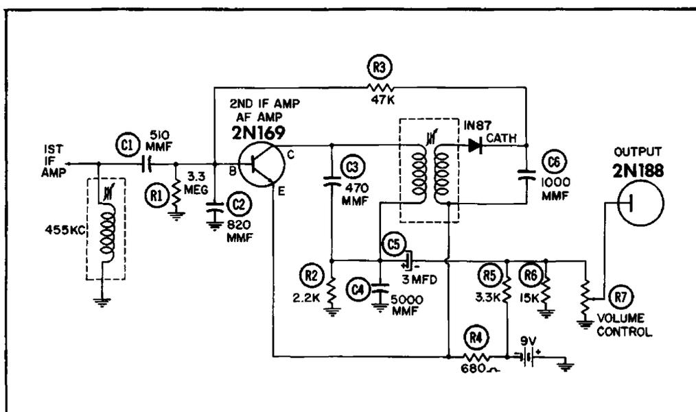
Fig. 14-5. Reflex transistor amplifier.
