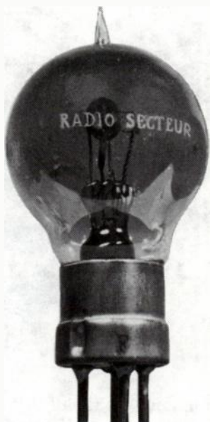
Fig. 19-12. Métal's first ac tube, the Radio Secteur, 1922.
