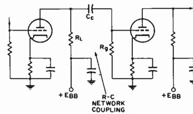
Fig. 11. Resistance-coupled triodes.
