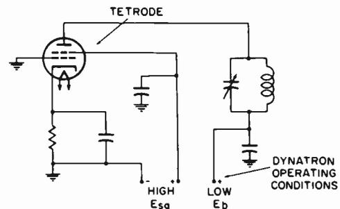
Fig. 19. Dynatron oscillator.
