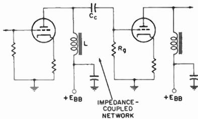
Fig. 12. Impedance-coupled triodes.
