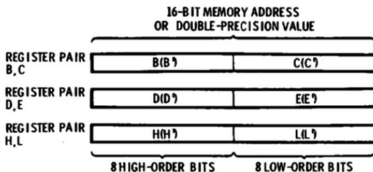
**Fig. 2-4. Register pairs.**
