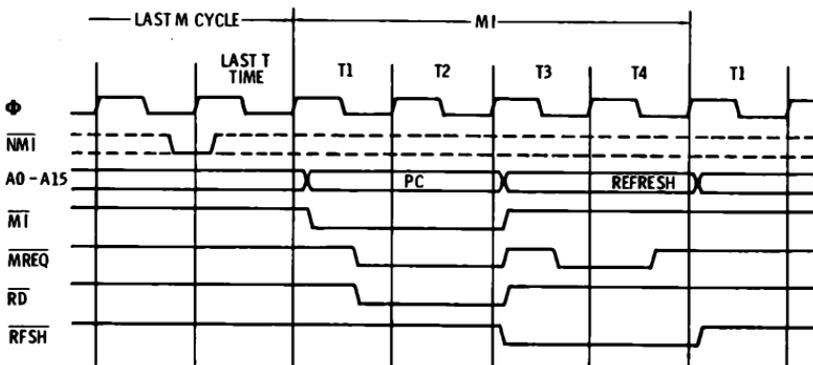
Fig. 3-10. Nonmaskable Interrupt Request cycle.
