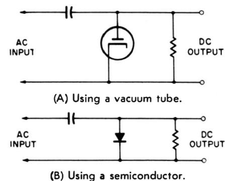
Fig. 4-2. A shunt-type diode rectifier circuit.
