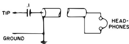
**Fig. 6-10. AF signal-tracer probe.**
