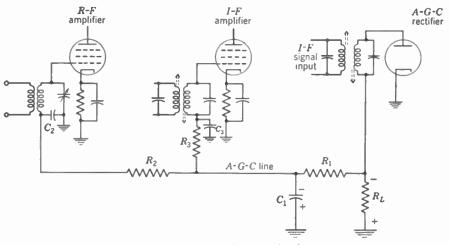
FIG. 15-1. A simple a-g-c circuit.
