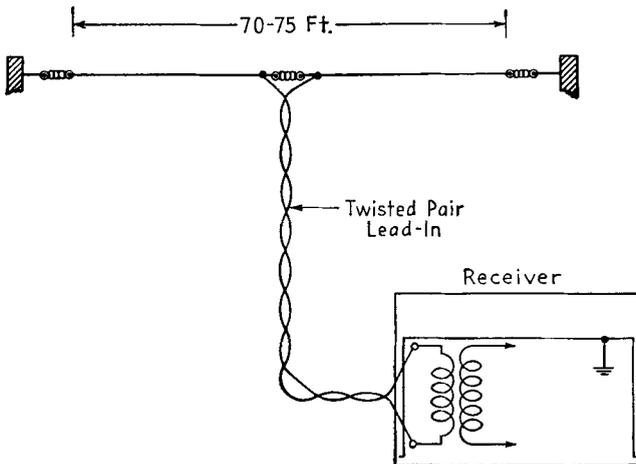
FIG. 17-23. The hertzian dipole antenna.
