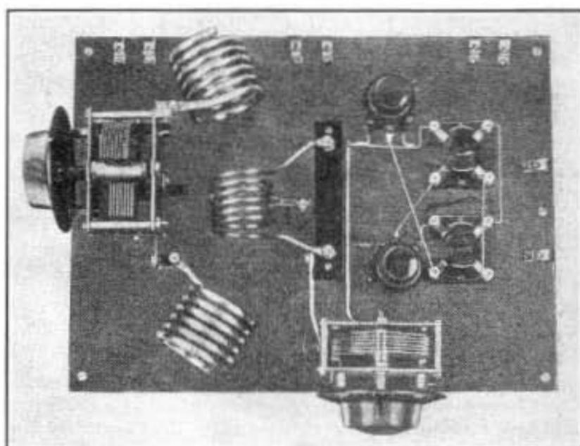
PLAN VIEW OF THE LOW-POWER PUSH-PULL AMPLIFIER
