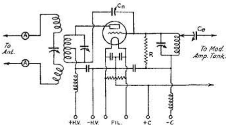
CIRCUIT OF A SINGLE-ENDED LINEAR AMPLIFIER
