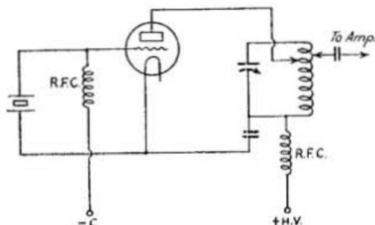
THE POWER CRYSTAL OSCILLATOR CIRCUIT
