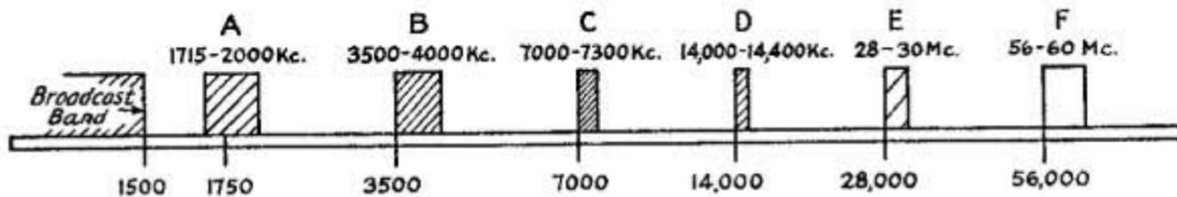
RELATIVE POSITION AND WIDTH OF THE AMATEUR BANDS IN THE HIGH FREQUENCY SPECTRUM
