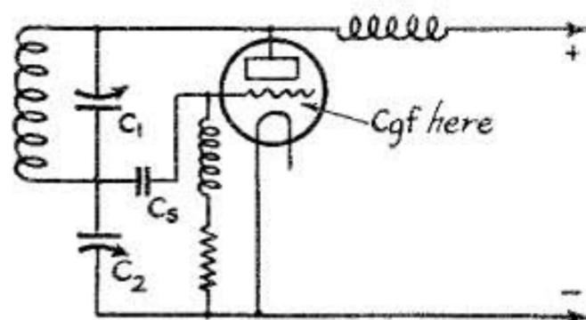
A SHUNT-FEED ULTRAUDION CIRCUIT
