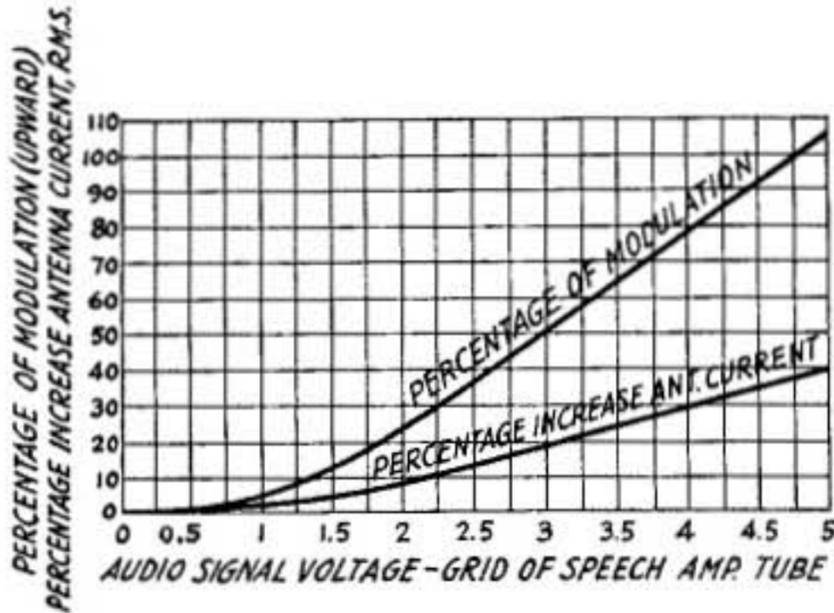
MODULOMETER PERFORMANCE CURVES OF A 'PHONE TRANSMITTER
