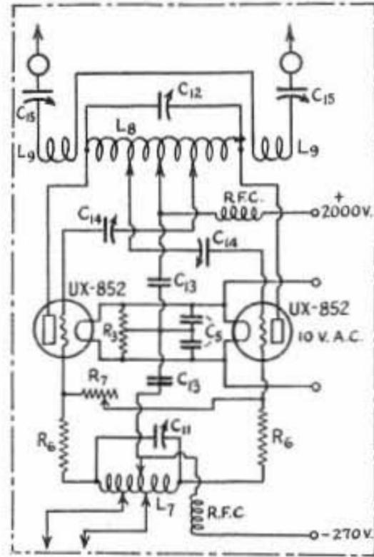
THE 150-WATT PUSH-PULL AMPLIFIER CIRCUIT
