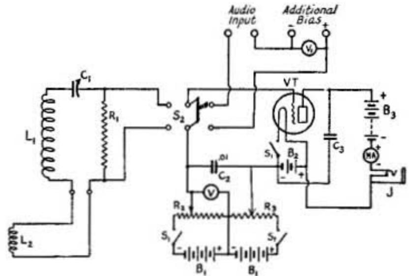
SCHEMATIC CIRCUIT OF THE MODULOMETER
