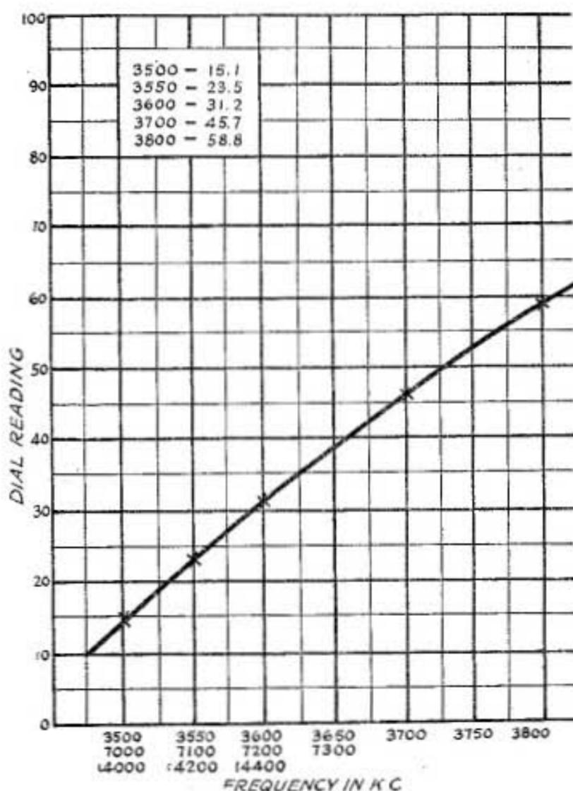
TYPICAL CALIBRATION CURVE FOR THE FREQUENCY METER
