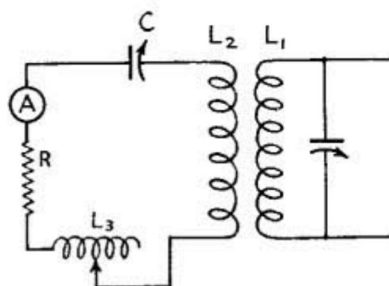
A SUITABLE DUMMY ANTENNA FOR TRANSMITTER TESTING
