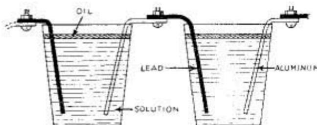
TYPICAL CHEMICAL RECTIFIER CELLS
