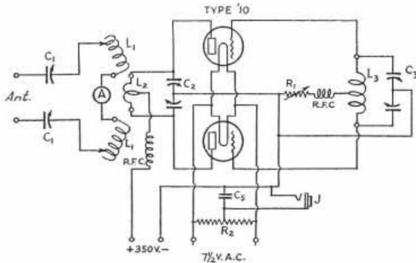
A PUSH-PULL T.G.T.P. CIRCUIT FOR TYPE '10 TUBES
