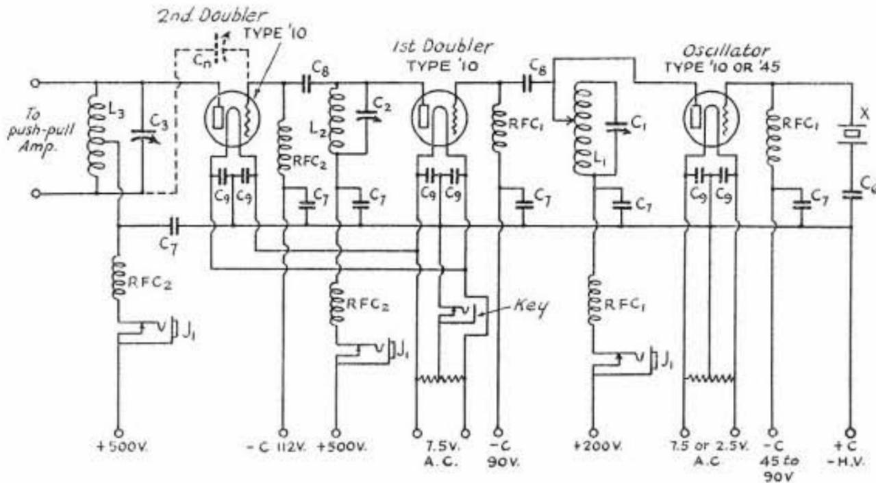
THE OSCILLATOR AND FREQUENCY-DOUBLER CIRCUIT
