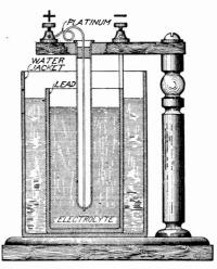
Fig. 27. Wehnelt Interrupter
