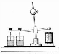
Fig. 25. Foucault Mercury Break
