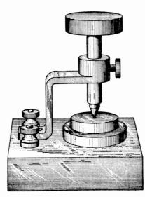
Fig. 45. Silicon Detector
