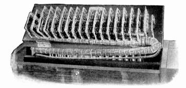
Fig. 186. Keyboard Wiring
