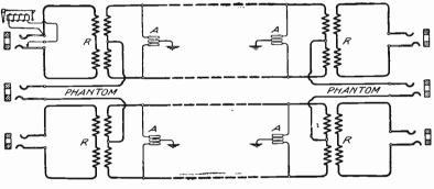
Fig. 225. Phantom Circuit
