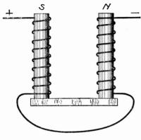
Fig. 20. Electromagnet
