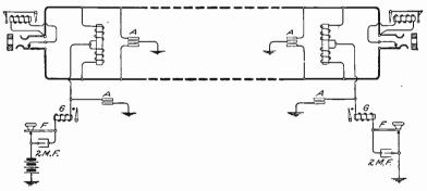
Fig. 231: Simplex Telegraph Circuit
