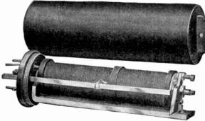
Fig. 217. Trunk Relay
