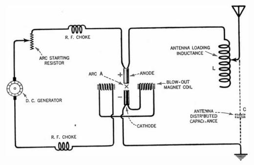
FIG. 20.-A fundamental arc circuit.
