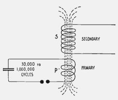
Fig. 40-Radio Frequency Transformer.
