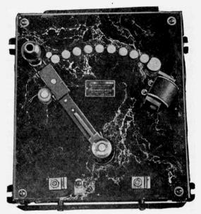
Fig. 71a-Cutler-Hammer Hand Motor Starter.
