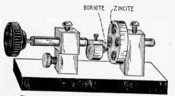
Fig. 159-The Zincite Bornite Detector.
