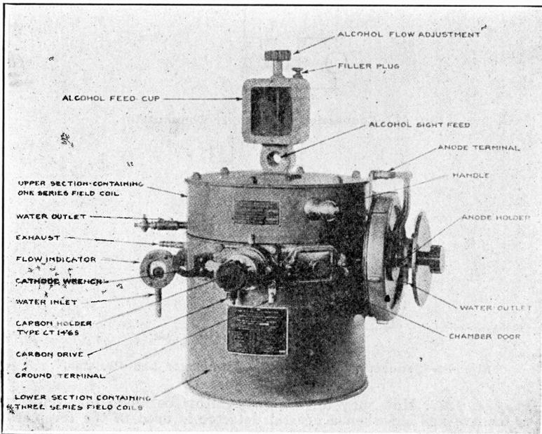
Fig. 45.—The Arc Converter.
