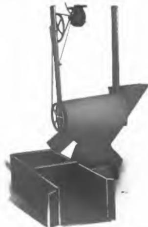
Fig. 3. Motor Driven Ash Sifter
