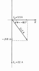
Fig. 32 · 13 Phasor Diagram for Circuit of Fig. 32 · 12
