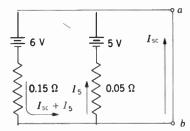
Fig. 22 · 36 Determination of  $I_{\rm N} = I_{\rm sc}$  for Fig. 22 · 35
