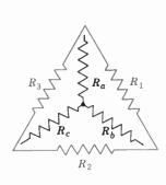
Fig. 22 · 27 Resistance Equivalents
