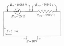
Fig. 14 · 13 Voltmeter Circuit of Example 3
