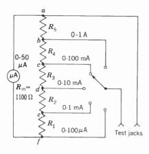
Fig. 14 · 10 Multicurrent Meter Circuit of Prob. 6.
