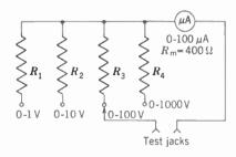
Fig. 14 · 22 Multirange Voltmeter Circuit of Prob. 3.
