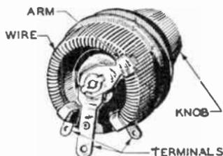
Fig. 3. Wire-Wound Rheostat-Potentiometer Used in Radio
