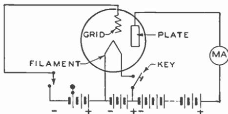
Fig. 3. Radio-Tube Circuit
