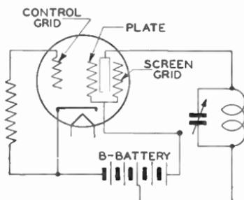
Fig. 11. Dynatron Oscillator
