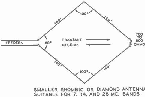
SMALLER RHOMBIC OR DIAMOND ANTENNA SUITABLE FOR 7, 14, AND 28 MC. BANDS
