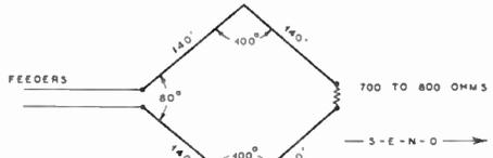
SMALLER RHOMBIC OR DIAMOND ANTENNA SUITABLE FOR 7, 14 & 28MC. BANDS
