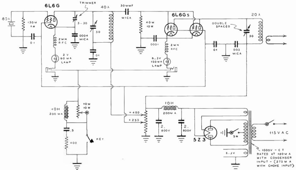
**SMALL CW TRANSMITTER OR HIGH POWERED EXCITER UNIT**
