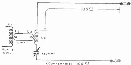
**Figure 42—Link Coupling to 160-Meter Antenna System.**
