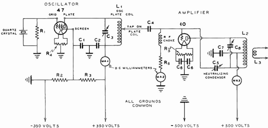
CRYSTAL OSCILLATOR — BUFFER — AMPLIFIER CIRCUIT
