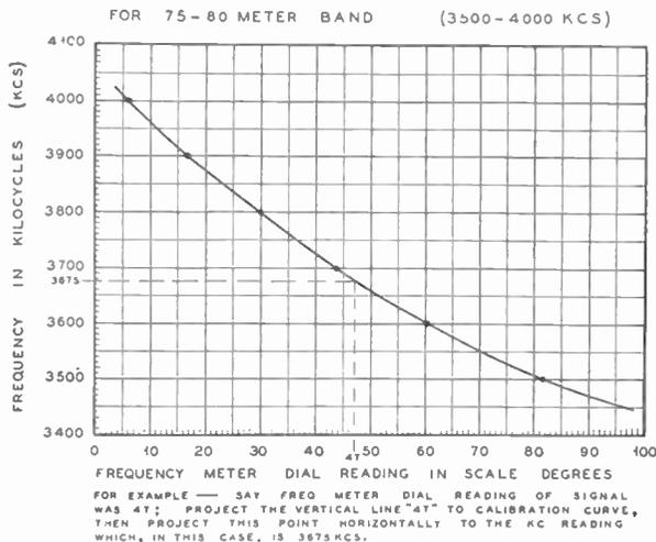
**Figure 22—Frequency Meter Curve.**
