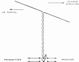
**Figure 88—Tilt Doublet Antenna.**
