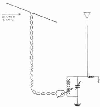
**Figure 91—Tilt Bucking Antenna System.**
