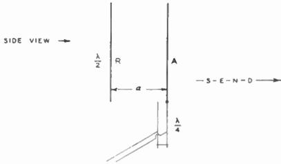
PARASITIC REFLECTOR  $\frac{\lambda}{4}$  IN BACK OF  $\frac{\lambda}{2}$  ANTENNA
