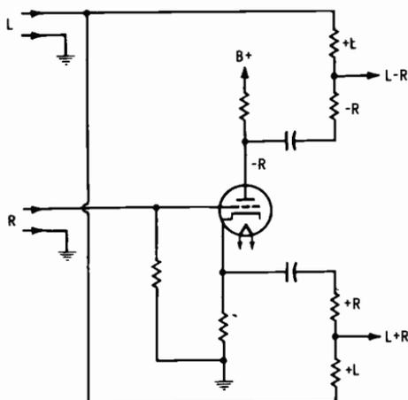
Fig. 10-31. Inverter-tube stereo matrix.
