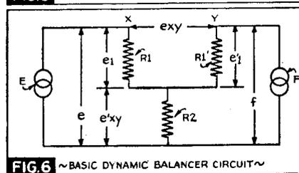
FIG. 6 ~ BASIC DYNAMIC BALANCER CIRCUIT ~
