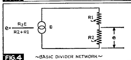
FIG. 4 ~ BASIC DIVIDER NETWORK ~
