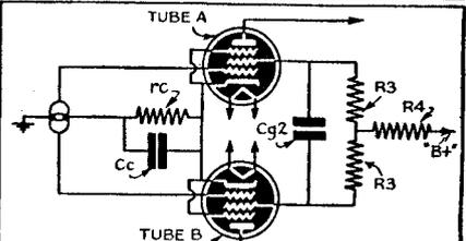
**FIG. 9** ELEMENTS OF THE DYNAMIC SCREEN-GRID BALANCER
