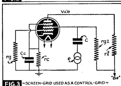
FIG. 3 ~ SCREEN-GRID USED AS A CONTROL-GRID ~
