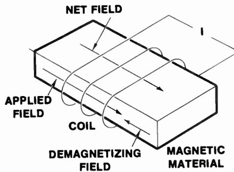
Fig. 34 Demagnetization Field
