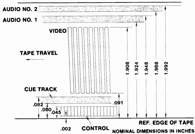
Fig. 61 Quadruplex Format
