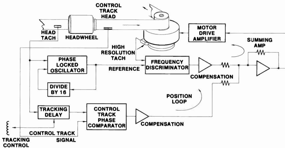
Fig. 114 Analog Capstan Servo for Quad
