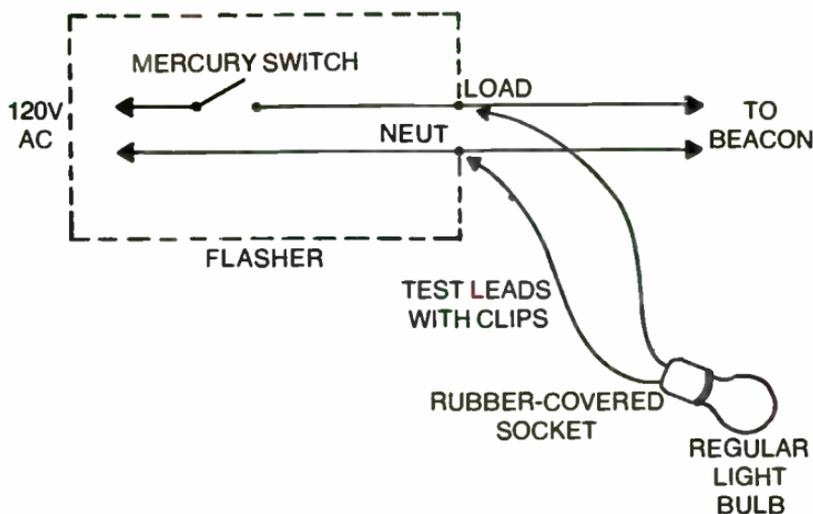
Fig. 12-7. A simple flasher test unit.
