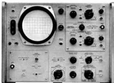
**175A 50 MHz OSCILLOSCOPE.**
