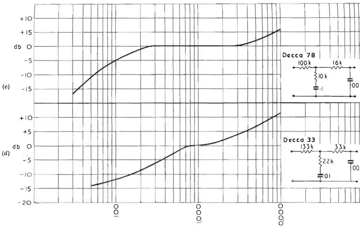
FIG. 7. 29(c)-(d). Recording characteristics and correction circuits. (c) Decca 78 ; (d) Decca 33.
