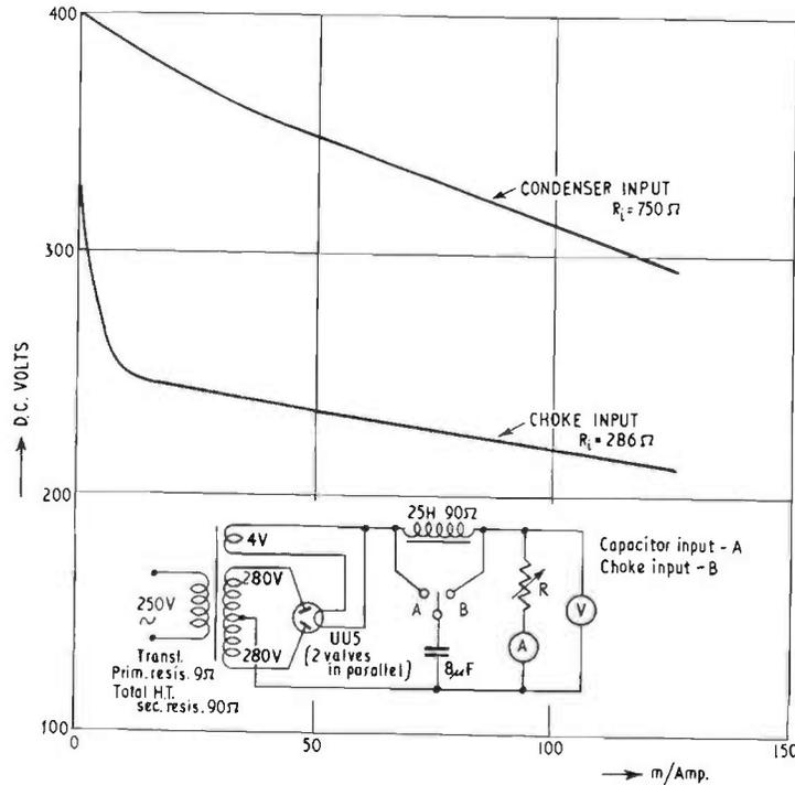
FIG. 14.5. Choke input rectifier circuit.
