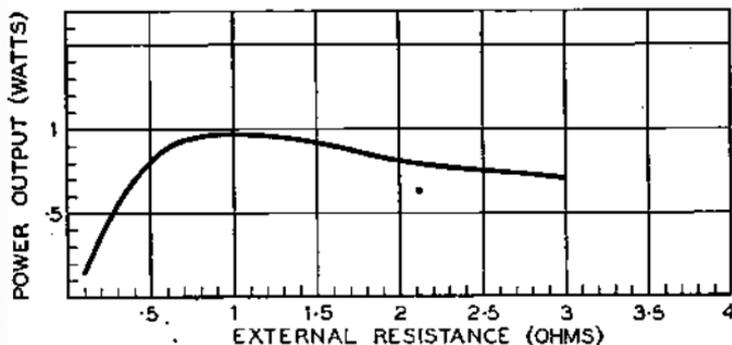
FIG. 24.—THE POWER DELIVERED BY A BATTERY.
