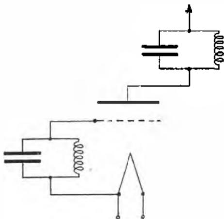
FIG. 95.—TUNED GRID-TUNED PLATE OSCILLATOR.
