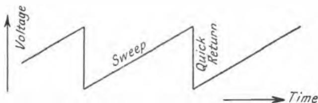
FIG. 133.—GRAPH OF VOLTAGE REQUIRED FROM A TIME BASE CIRCUIT.
