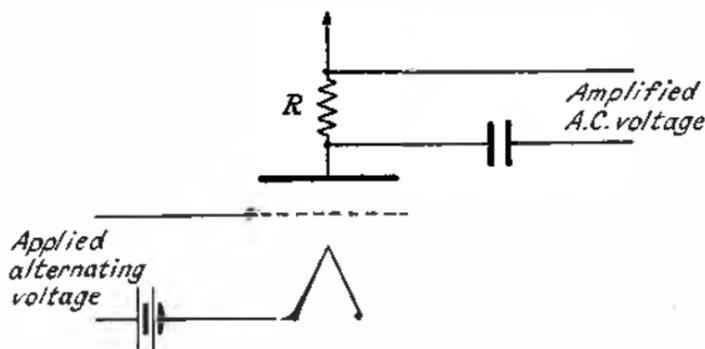
FIG. 114.—THE RESISTANCE CAPACITY CIRCUIT.
