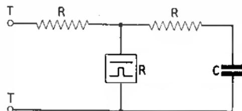
FIG. 177.—NEGATIVE INDUCTANCE CIRCUIT.
