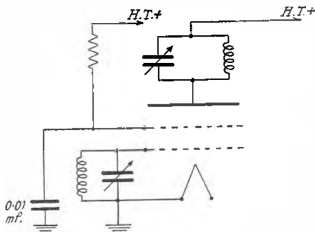
FIG. 119.—THE TETRODE FOR H.F. AMPLIFICATION.
