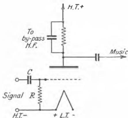
FIG. 108.—LEAKY GRID DETECTOR.
