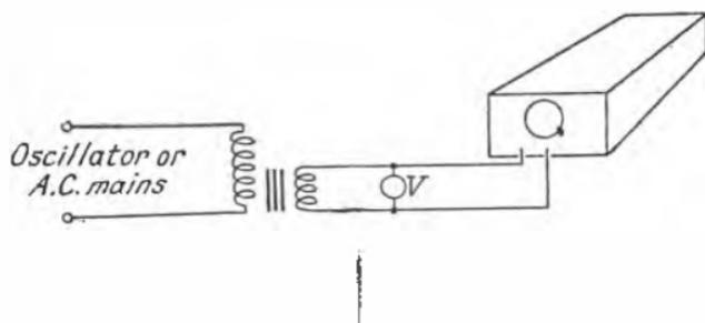
FIG. 115.—CALIBRATION OF OSCILLOGRAPH.
