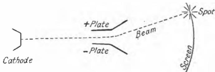
FIG. 132.—THE DEFLECTOR PLATES IN THE OSCILLOGRAPH.
