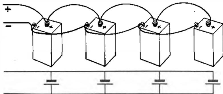
FIG. 6.—BATTERIES IN PARALLEL.
