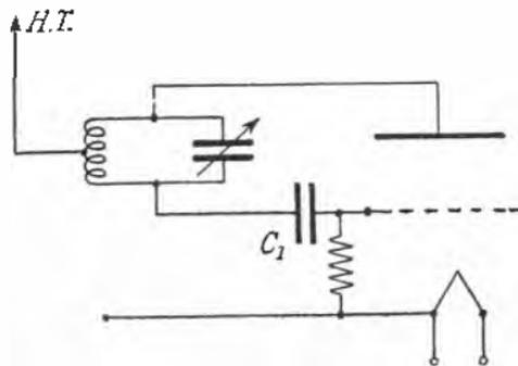
FIG. 92.—THE HARTLEY OSCILLATOR.
