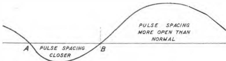
FIG. 100.—TRANSMISSION OF A MESSAGE BY PULSE-TIME MODULATION.
