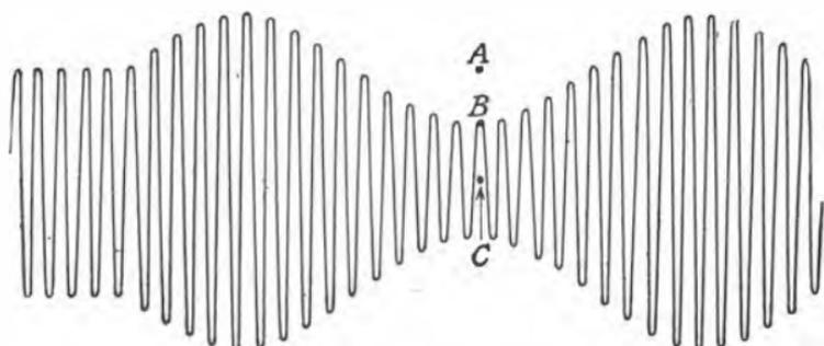
FIG. 96.—MODULATION OF HIGH FREQUENCY CARRIER WAVE.
