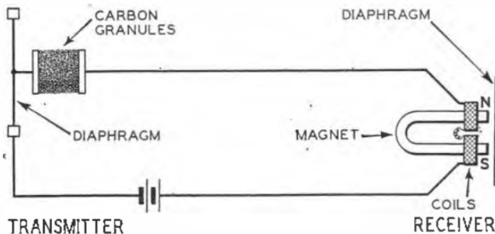
FIG. 60.—TELEPHONE TRANSMITTER CIRCUIT.
