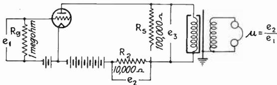
(d) Complete Circuit for Measuring Amplification Factor
