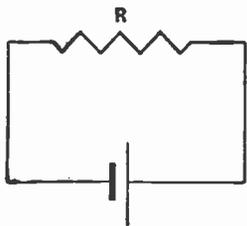
Fig. 28.—A simple circuit.
