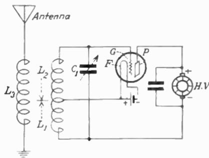
FIG. 133.—Hartley circuit.
